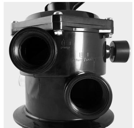
Am Ausgang „canal/waste“ (seitlich davon befindet sich das Schauglas) wird die Rückspüleleitung hergestellt, welche das schmutzige Wasser beim Rückspülen und Nachspülen sowie in der Ventilstellung „Entleeren“ das angesaugte Wasser direkt ableitet.
